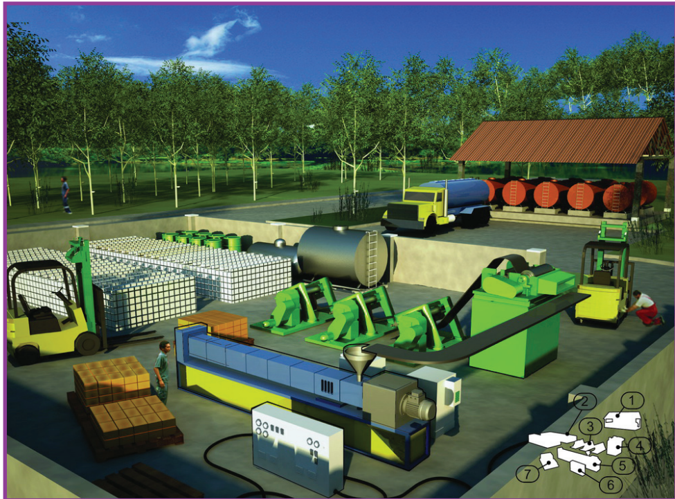
รูปที่ 3 รูปแสดงการประยุกต์ใช้กรรมวิธีการทำยางธรรมชาติให้แห้งแบบต่อเนื่องวิธีใหม่สำหรับการผลิตยางแห้ง ด้วยเครื่องอัดรีดแบบสกรูคู่แทนขั้นตอนการอบด้วยเตาอบความร้อนในกระบวนการผลิตปัจจุบัน
