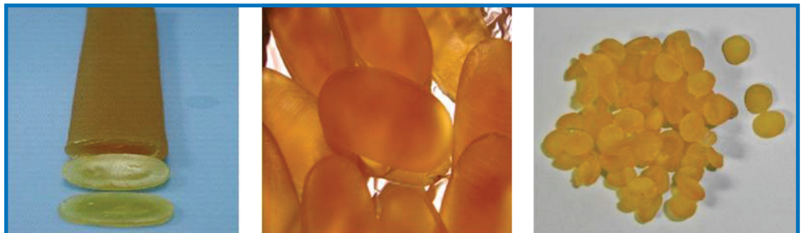
รูปที่ 2 รูปแสดงยางแท่งรูปทรงต่างๆที่ผลิตได้จากเครื่องอัดรีดแบบสกรูคู่
