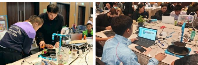
นักเรียนกำลังสร้างเครื่องรดน้ำต้นไม้อัตโนมัติ โดยเขียนโค้ดคำสั่งควบคุมบอร์ด KidBright ให้รดน้ำตามเวลาที่กำหนด
