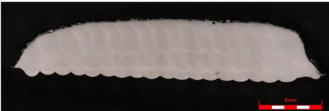
ภาคตัดขวางของผิวเคลือบเหล็กโครเมียมที่เคลือบด้วย laser cladding
