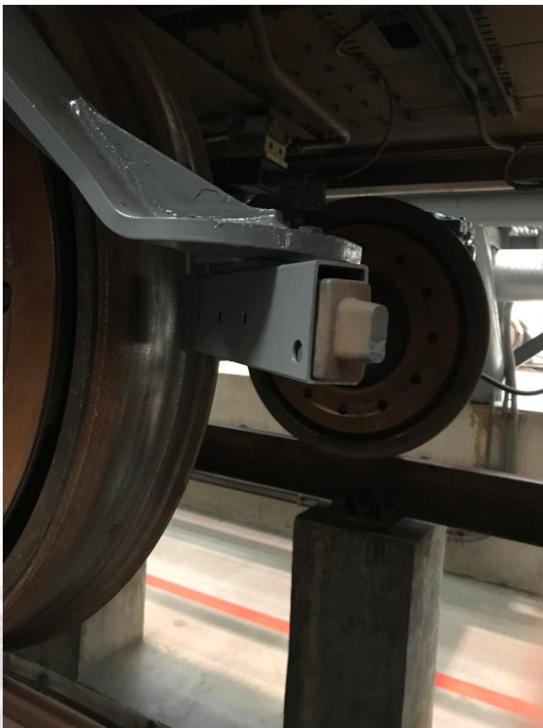
การติดตั้งขณะใช้งาน และลักษณะการสึกหรอของชิ้นงานแท่งหล่อสแตน
