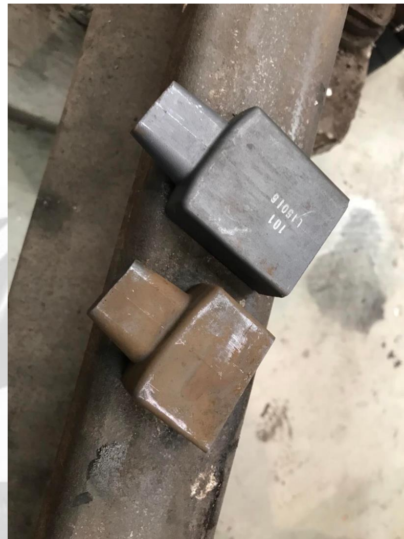
การติดตั้งขณะใช้งาน และลักษณะการสึกหรอของชิ้นงานแท่งหล่อสแตน
