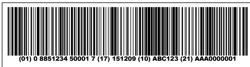
ภาพที่ 4- 4 สัญลักษณ์บาร์โค้ดแบบ 1 มิติ ชนิด GS1-128
