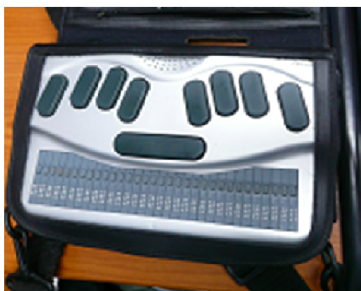
แผนภาพที่ 3.2 เครื่องบันทึกส่วนบุคคลระบบแสดงผลอักษรเบรลล์ (Braille note-taker)
