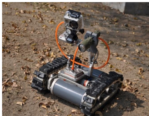
รถสำรวจรุ่นที่ 2 ปรับลดน้ำหนักลง ที่ 7 kg. ปรับปรุงล้อขับเคลื่อน เป็นล้อตีนตะขาบ
