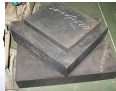
ยางรองคอสะพาน
