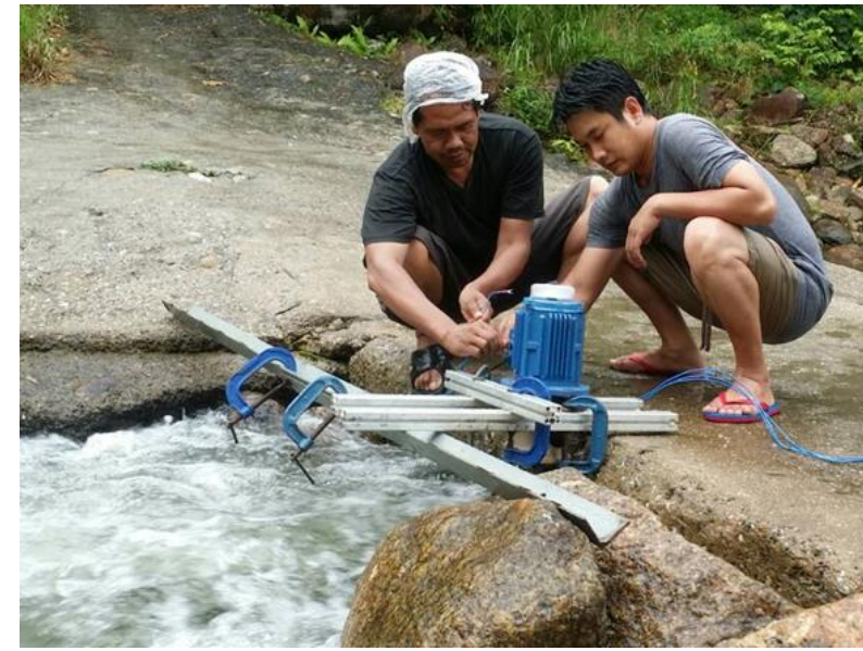
ชุดกังหันกระแสน้ำ (60 W @ V=3m/s, A= 0.061m 2 ) ประสิทธิภาพ 7%
