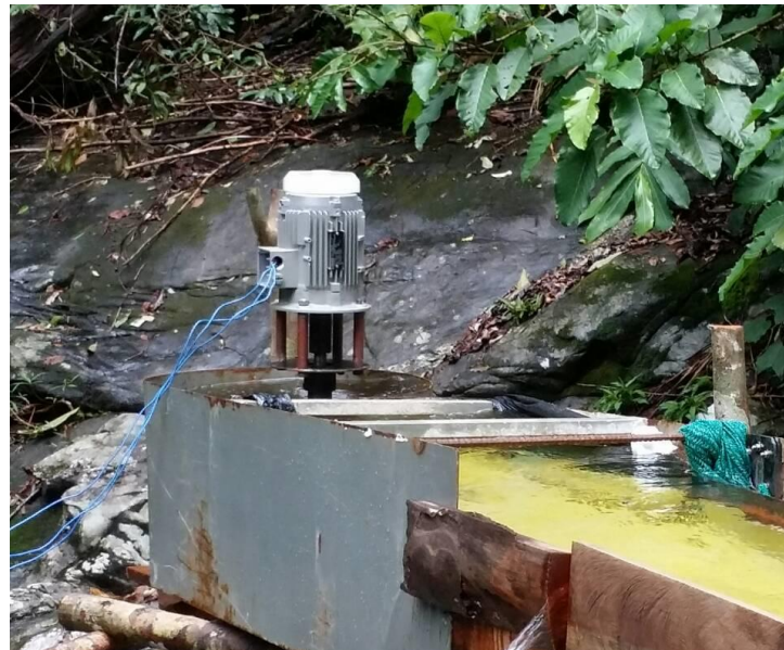
ชุดกังหันน้ำใบพัด (150 W @ H=2.5 m, Flow 10 l/s) ประสิทธิภาพ 56%
