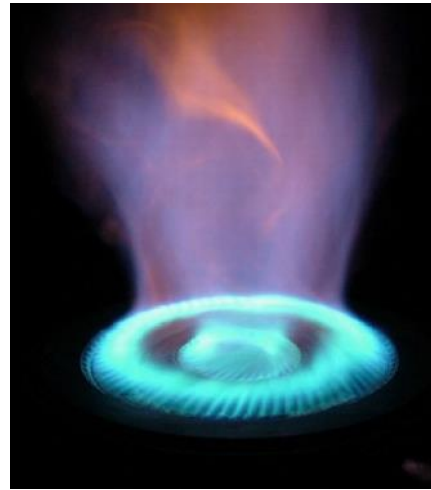
รูปที่ 1 ภาพถ่ายเปลวไฟของเตาแก๊สชนิดความดันสูง
