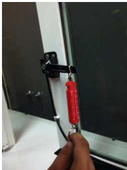
รูปที่ 9 การทดสอบหาแรงที่ใช้ปลดล็อกแบบคันโยกด้วยมือ
