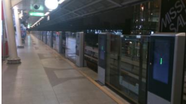
รูปที่ 1 Half Height Platform Screen Door (HHPSD)
