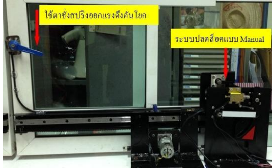
รูปที่ 8 การทดสอบระบบปลดล็อกแบบคันโยกด้วยมือ
