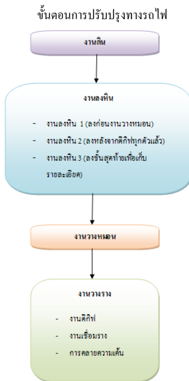
รูปที่ 1 ขั้นตอนการปรับปรุงทางรถไฟ
