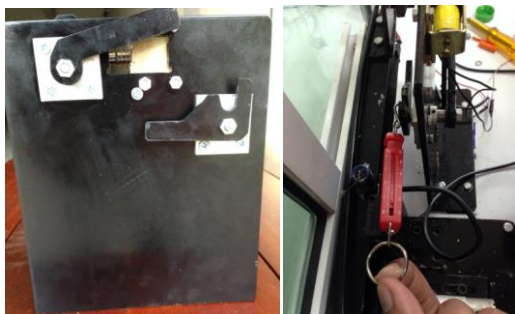
รูปที่ 10 การทดสอบแรงที่ใช้ในการล็อก
