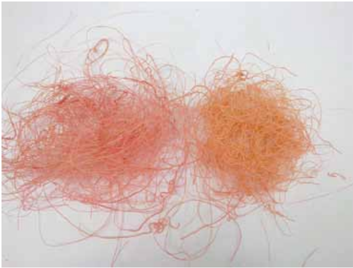
เส้นใยที่เปลี่ยนสีได้จากสภาวะการผลิตเดียวกัน (ชายมีอุณหภูมิสูงกว่า 31°C และขามีอุณหภูมิต่ำกว่า 31°C)
