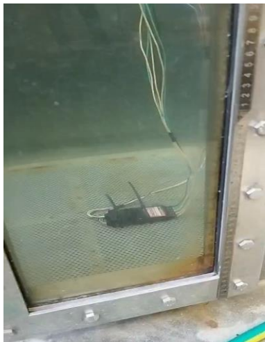
ทดสอบ IP68 แบบมีการจ่ายไฟจริง 600-800 V
