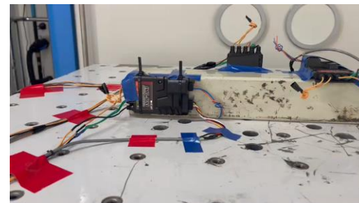
ทดสอบรองรับการสั่นสะเทือน UNECE R100 แบบมีการจ่ายไฟจริง 600 V
