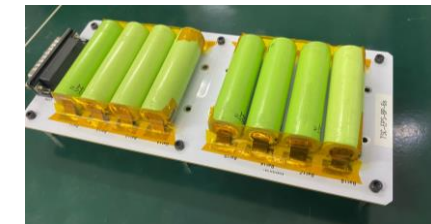
ต้นแบบระยะที่ 2 Battery Pack + BMS 8S4P
