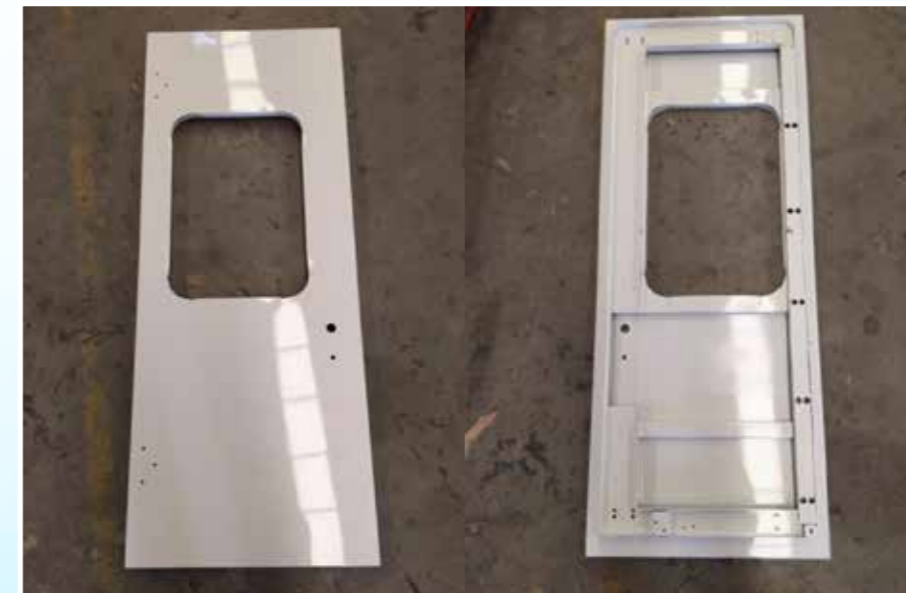
บานประตูแบบปรับปรุงด้านหน้าและด้านหลังที่ติดตั้งบนรถพยาบาลรุ่นปัจจุบัน The development of front and rear door panels that installed on current ambulances.
