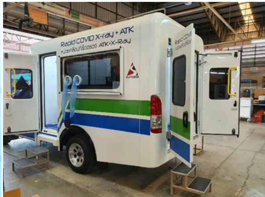
รถพยาบาลที่ได้ติดตั้งประตูจากการออกแบบและพัฒนาโดยทีมวิจัยเอ็มเทค Ambulances that installed with doors from the design and development by MTEC research team.
