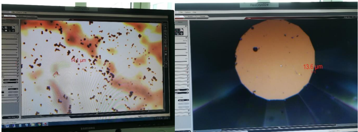
รูปที่ 16 การนำผลึก Ruby มาวางไว้ตรงกลาง Diamond cell
