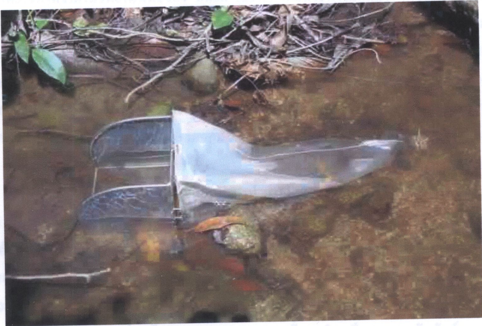
ภาพ 8 อุปกรณ์ Surber sampler ที่ใช้ในการเก็บตัวอย่างแมลงหนอนปลอกน้ำในเชิงปริมาณ
