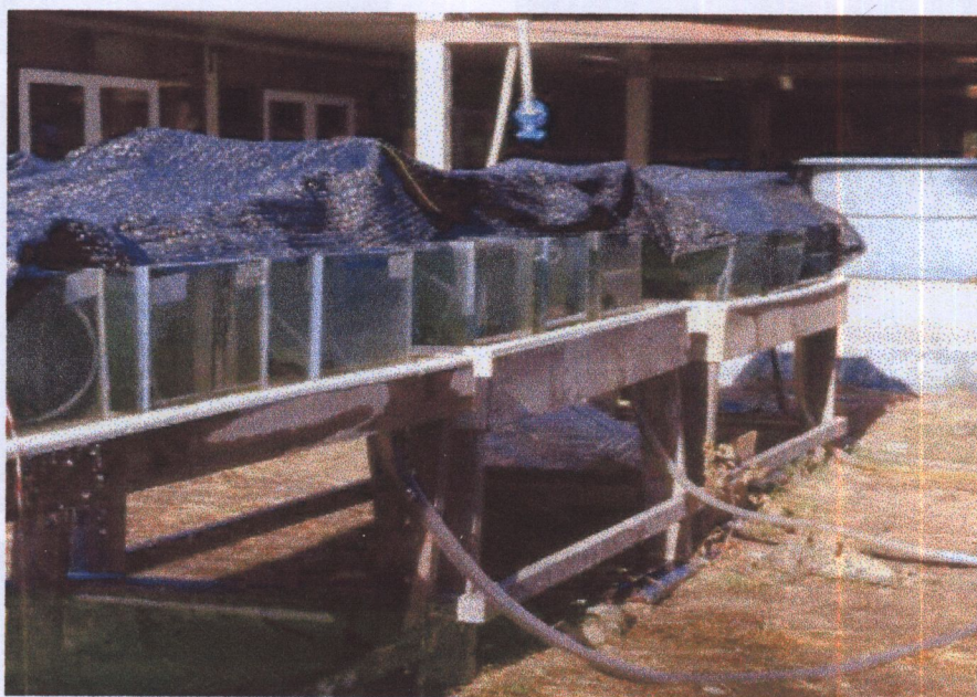
รูปที่ 3 ตู้ทดลองจัดไว้กลางแจ้ง โดยมีระบบน้ำแบบไหลผ่านตลอด
