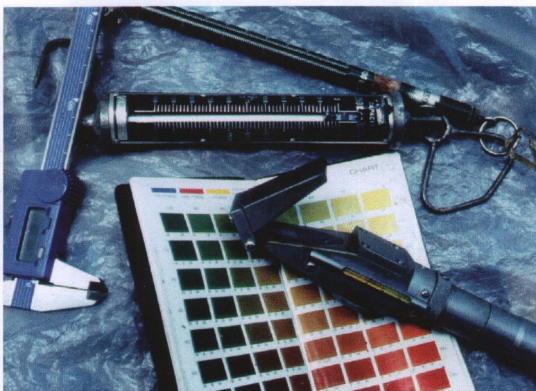
ภาพผนวกที่ 3 อุปกรณ์สำหรับศึกษาลักษณะของอาหาร ได้แก่ เครื่องชั่งน้ำหนัก, Caliper สำหรับวัดขนาด, Sugar refractor สำหรับวัดปริมาณน้ำตาล และ Color chart สำหรับเทียบสี
