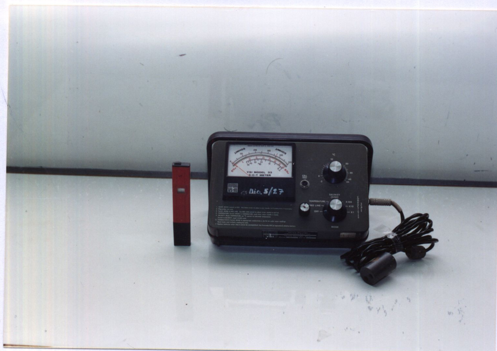
ภาพที่ 4 เครื่องมือที่ใช้ในการวัดอุณหภูมิ ค่าการนำไฟฟ้า และความเค็มของน้ำ (ขวามือ) และเครื่องมือวัดความเป็น กรด-ด่างของน้ำ (ซ้ายมือ)
