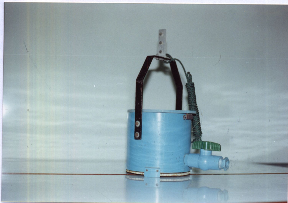
ภาพที่ 6 เครื่องมือเก็บตัวอย่างน้ำความจุ 5 ลิตร
