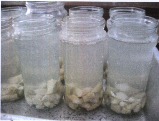
ก ขั้นตอนการย่อยหินปูนออกจากชิ้นส่วนของปะการังด้วยสารละลายกรดอะซิติก
