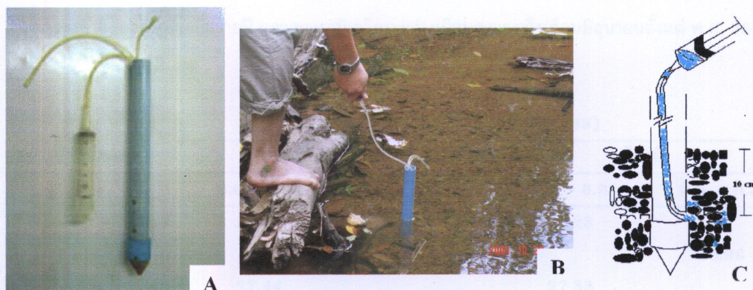
ภาพที่ 7 อุปกรณ์ที่ใช้เก็บตัวอย่างน้ำในชั้นตะกอน (pore water lance) (A) ขณะเก็บตัวอย่างน้ำในภาคสนาม (B) และภาพจำลองเหตุการณ์ในท่อนขณะเก็บตัวอย่าง (C)
