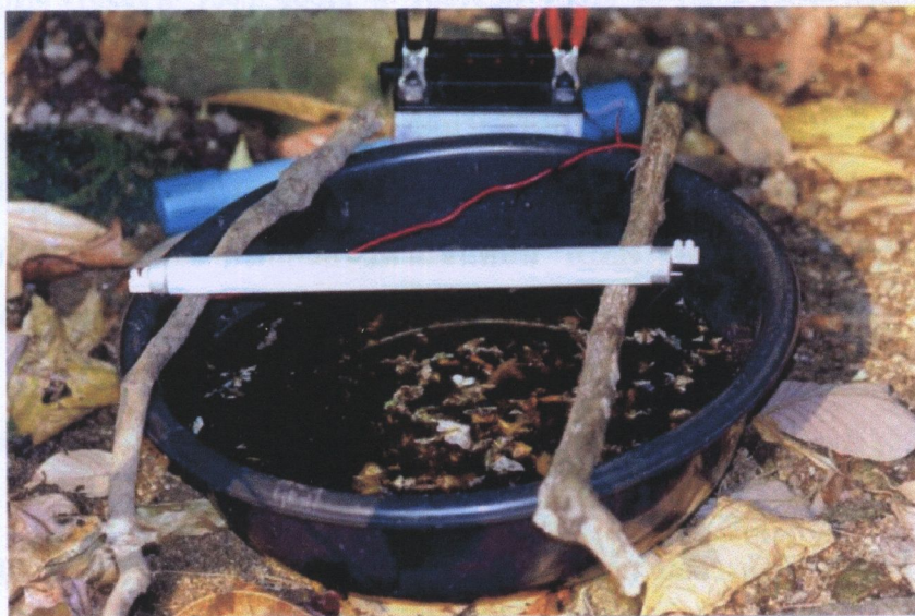
ภาพ 9 อุปกรณ์กับดักแสงไฟ (light trap) ที่ใช้ในการเก็บตัวอย่างแมลงหนอนปลอกน้ำตัวเต็มวัย
