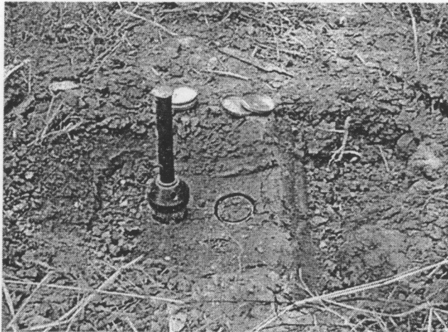
ภาพที่ 11 การเก็บตัวอย่างดินเพื่อหาความหนาแน่นและส่วนประกอบของดิน
