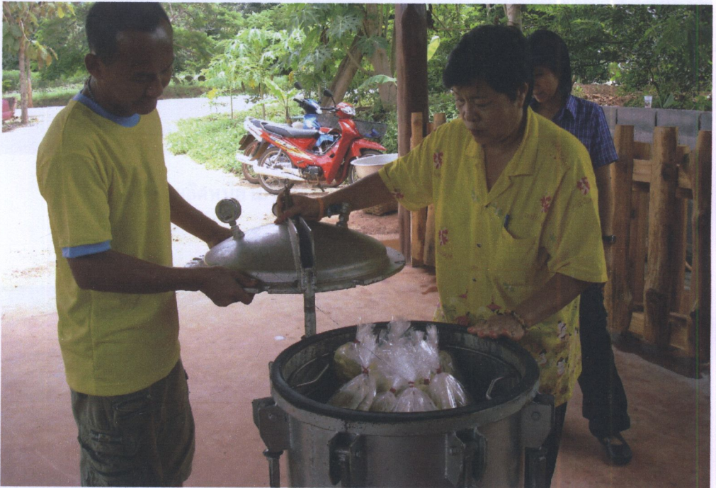
ภาพที่ 4.1 การผลิตหน่อไม้ไผ่รวกนึ่งโดยใช้หม้อนึ่งความดัน (วิธี A และ B)
