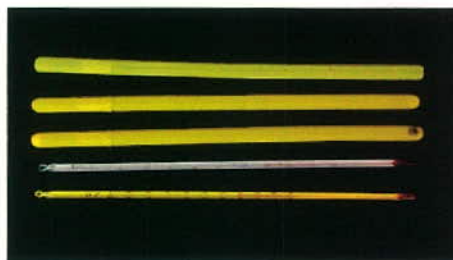
ภาพที่ 1 เทอร์โมมิเตอร์ทำด้วยแอลกอฮอล์
