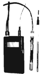
pH Meter และหัววัด (probe) ซึ่งพัฒนาขึ้นเองในประเทศไทย
