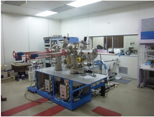
รูปที่ 4.1 เครื่อง MBE ชุดแรกที่ใช้ในการพัฒนา โครงสร้าง Quantum Dots ของ InAs
